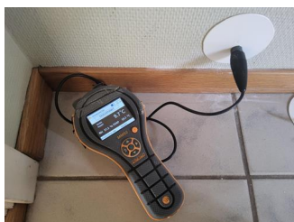
Utført kontroll i tillegg til konstruksjon - Fuktmåling
