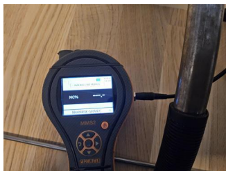
Utført kontroll i tilleggende konstruksjon - Fuktmåling fra soverom.
