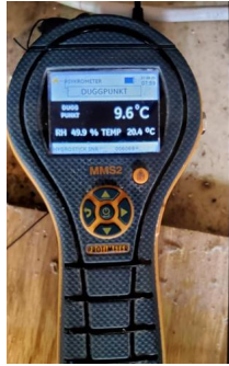
Utført kontroll i tilliggende konstruksjon - Fuktmåling
