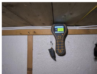
Kontroll i lukkede konstruksjoner ikke utført - Fuktmåling i himling
