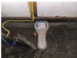
Kontroll i lukkede konstruksjoner ikke utført - Fuktmåling i klelekt
