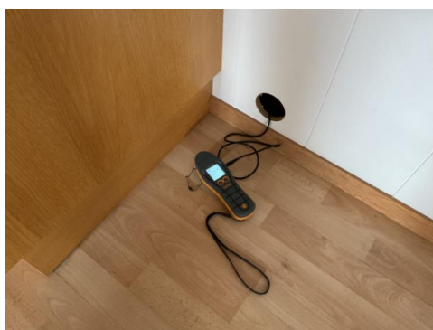
Fuktmåling i tilliggende konstruksjon.
