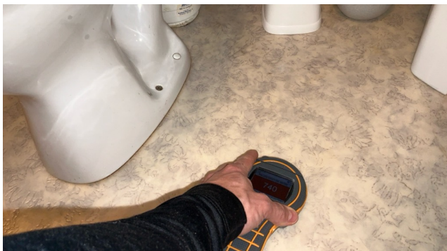
Eksempel overflatemåling med forhøyede verdier.
