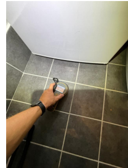
Forhøyede verdier ved overflatesøk på flislagte overflater.
