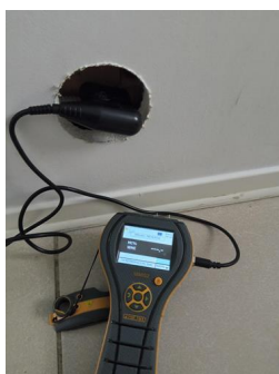
Utført kontroll i tilliggende konstruksjon - Fuktmåling
