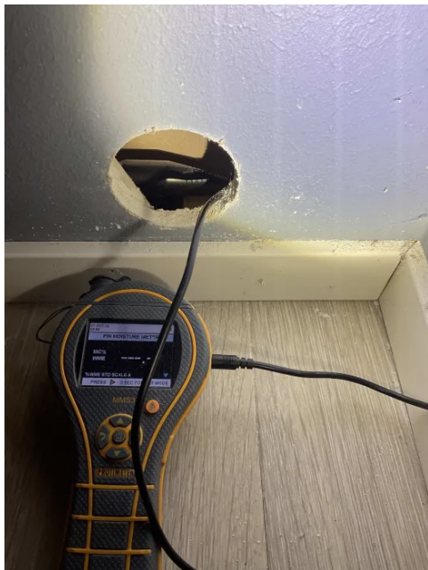
Fuktsøk med hulltaking, ingen unormale verdier
