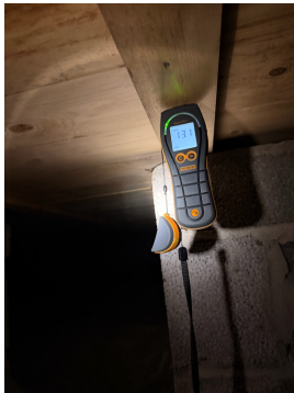
Fuktmåling i konstruksjonen registrerte normale forhold.
