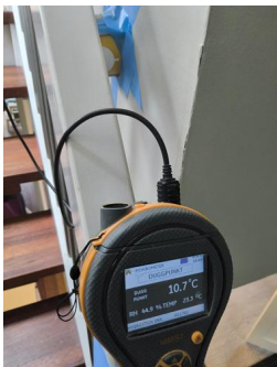
Utført kontroll i tilliggende konstruksjon - Fuktmåling
