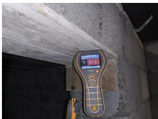
Kontroll i lukkede konstruksjoner ikke utført - Fuktmåling i treverket
