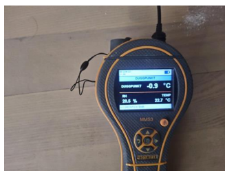
Utført kontroll i tiliggende konstruksjon - Fuktmåling
