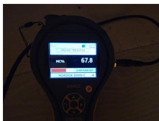
Kontroll i lukkede konstruksjoner - Fuktmåling utlektet kjellevegg.
