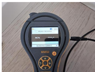
Utført kontroll i tilliggende konstruksjon - Fuktmåling bad.
