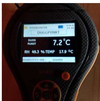
Utført kontroll i tiliggende konstruksjon - IMG_20260603_122219
