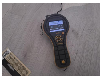
Utført kontroll i tiliggende konstruksjon - Fuktmåling
