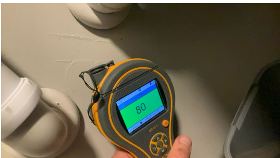
Vegg: Ved bruk av fuktindikator på utsatte steder registrerte jeg ingen unormale verdier.
