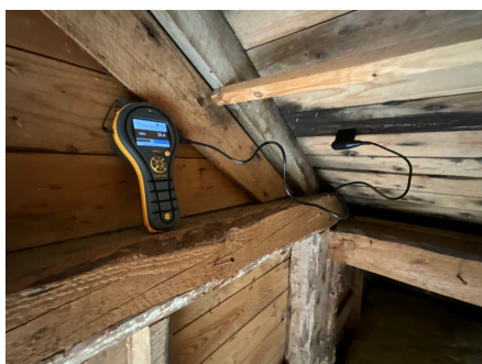
Fuktmåling ved gavl mot sørøst. Måling viser 15,4% og ingen forhøyde avvik
