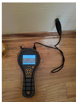
Utført kontroll i tilliggende konstruksjon - Relativ luftfuktighet
