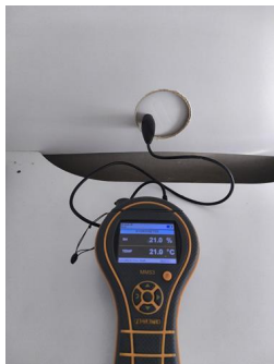
Utført kontroll i tilliggende konstruksjon - Fuktmåling
