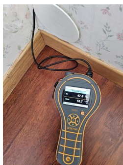
Utført kontroll i tilliggende konstruksjon - Fuktmåling.
