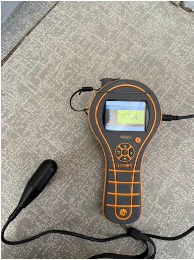
Fukmåling i gulv forran oppvaskbenk
