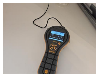
Utført kontroll i tilliggende konstruksjon - Fuktmåling.
