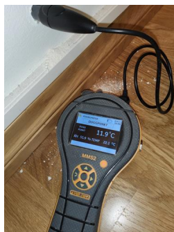
Utført kontroll i tilliggende konstruksjon - Fuktmåling
