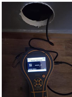
Utført kontroll i tilliggende konstruksjon - Fuktmåling.
