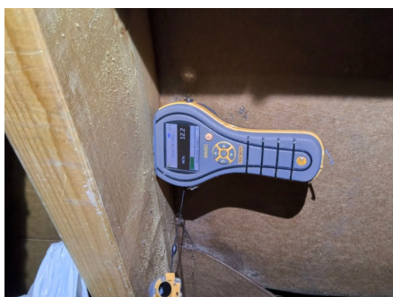
Ved enkel fuktmåling registrerte jeg tørre verdier.
