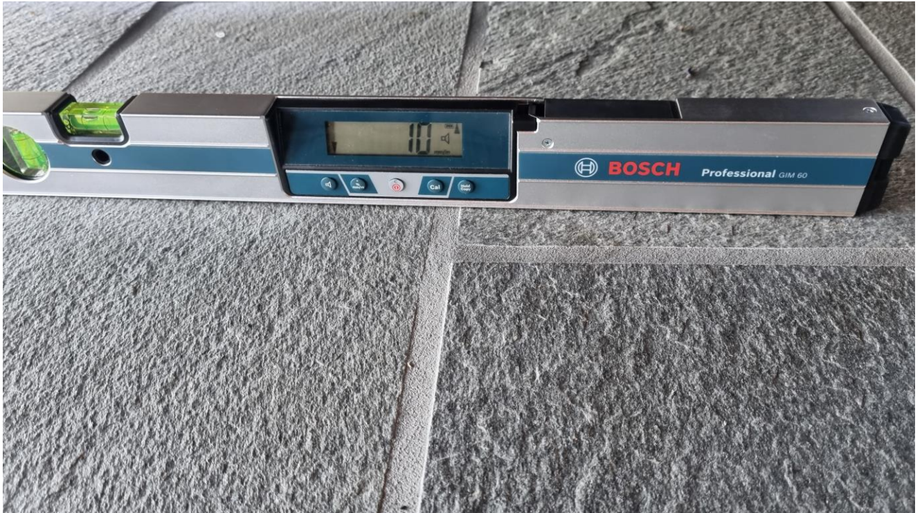
Balkonggulv i 2.etasje har et motfall (fall innover på omkring 10 mm /m.
